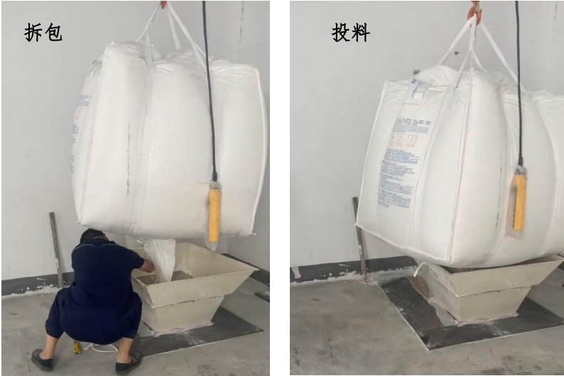
图 4.1-3 玉米淀粉拆包、投料示意图
